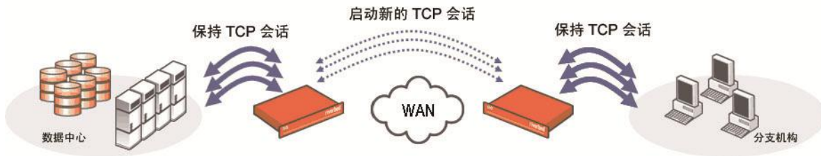
图 2: RiOS 通过广域网建立一个新的 TCP 会话，以此优化广域网传输，无需更改现有的基础设施。
